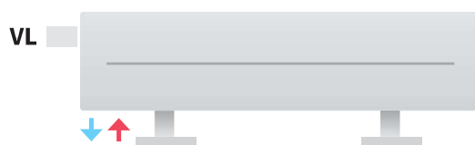
VL med termostatventil till vänster
